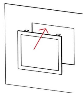
Панельный компьютер устанавливается в вырез в стене
