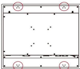
Для установки панели в стену предусмотрены специальные крепления
