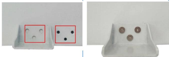
Закрепите держатель с помощью винтов на панели
